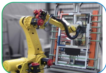
Robot lắp kính
